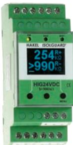
Hlídače izolačního stavu ISOLGUARD HIG\*VDC jsou určeny k monitorování izolačního stavu stejnosměrných IT soustav. Přístroje trvale sledují izolační stav obou větví izolované IT soustavy proti vztažnému bodu. U stacionárních zařízení to bývá obvykle vodič PE. Při snížení izolačního odporu v kladné věti R+ nebo záporné věti R- je tento stav signalizován nastavením relé KA1/KA2. Poruchový stav je zároveň indikován LED diodou na čelním panelu.
