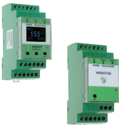
Hlídáč izolačního stavu ISOLGUARD HIG93T\* je určen k monitorování izolačního stavu jednofázových i třífázových izolovaných IT soustav navržených a provozovaných podle norem ČSN 33 2000-4-41, ČSN EN 50 155.
