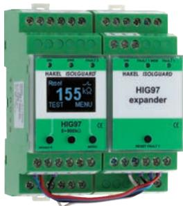
Hlídač izolačního stavu ISOLGUARD HIG97 je určen k monitorování izolačního stavu izolovaných IT soustav s požadovaným extrémně rychlým vyhodnocením a signalizací stavu kontrolované sítě navržených a provozovaných podle norem ČSN 33 2000-4-41, ČSN EN 61557-1;8. Hlídač je vybaven nezápalným měřícím obvodem testovaným dle ČSN EN 60079-11.
