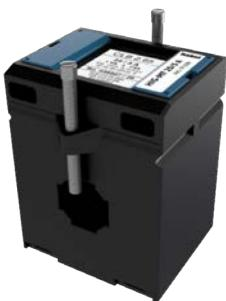
Řada měřicích transformátorů proudu HIG-MT slouží primárně ke snímání proudové zátěže zdravotnické izolované sítě, kterou monitoruje hlídač izolačního stavu od firmy HAKEL. Měřicí transformátory jsou k dostání v rozsahu primárního proudu 25 až 100 A a sekundárním proudem 5 A. provedení je násuvné. Transformátory jsou dodávány ve dvou rozměrových provedeních v závislosti na primárním proudu.
