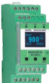
Hlídač monitoruje zdravotnické izolované soustavy až do maximálního provozního napětí 264 V AC. Umožňuje vyhodnocování tepelné a proudové zátěže oddělovacího transformátoru. Hlídač je vybaven displejem pro zobrazování číselné hodnoty naměřeného izolačního odporu a také hodnot proudové a tepelné zátěže oddělovacího transformátoru.
