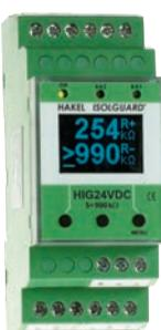
Hlídáče izolačního stavu ISOLGUARD HIG\*VDC/T jsou určeny k monitorování izolačního stavu stejnosměrných IT soustav. Přístroje trvale sledují izolační stav obou větví izolované IT soustavy proti vztažnému bodu. U stacionárních zařízení to bývá obvykle vodič PE. Při snížení izolačního odporu v kladné věti R+ nebo záporné věti R- je tento stav signalizován nastavením relé KA1/KA2. Poruchový stav je zároveň indikován LED diodou na čelním panelu.
