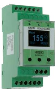
Hlídače izolačního stavu ISOLGUARD HIG93, HIG93/L, HIG94 jsou určeny k monitorování izolačního stavu jednofázových i trifázových izolovaných IT soustav navržených a provozovaných podle norem ČSN 33 2000-4-41, ČSN EN 61557-1;8.
