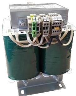
Jednofázové ochranné oddělovací transformátory se standardními plechy tvaru UI, skládaným jádrem a vertikální montáží, které jsou určeny pro napájení zařízení v místnostech pro léčebné účely.
