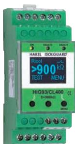
Hlídáč izolačního stavu ISOLGUARD HIG93/CL\* je určen k monitorování izolačního stavu jednofázových i třífázových izolovaných IT soustav navržených a provozovaných podle norem ČSN 33 2000-4-41, ČSN EN 61557-1;8.
