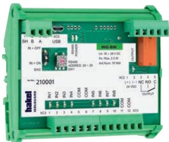
Modul vstupů a výstupu HIG-8IN je navržen jako rozšiřující zařízení pro systém sledování izolačního stavu HAKEL ISOLGUARD. Umožňuje doplnit kontrolu (typicky nemocniční) IT soustavy o libovolné signalizace pomocí 8 digitálních vstupů a 1 výstupního přepínačního kontaktu. Pomocí HIG-8IN může být sledován například stav UPS nebo záskokových automatů, čtení stisk alarmových nebo panikových tlačítek, případně jakéhokoli jiného zařízení, které je schopné předávat informace pomocí logického signálu.
