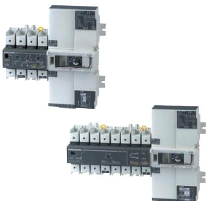
**ATyS M** jsou 2pólové a 4pólové modulární automatické přepínače sítí s integrovaným záskokovým automatem. Přednostní funkcí přístrojů je přepínání mezi hlavním a záložním přívodem při výpadku napájení. Jednotlivé typy se liší v možnostech a způsobu nastavení parametrů. Přístroje ATyS M pracují v automatickém režimu, v případě potřeby je možné přístroj přepínat ručně.
